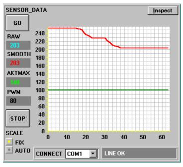
Die Sendeleistung sollte so eingestellt werden, dass der Empfänger des Sensors sich nicht in der Sättigung (A/D-Wert >240) befindet.
