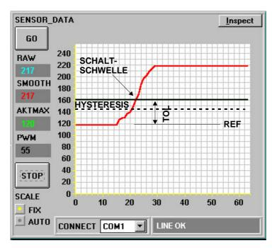
Das Messobjekt (Referenz-Teil, Gut-Teil) wird z.B. in der Lichtmessstrecke des Sensors so platziert, dass die Bedeckung durch das Messobjekt am Empfänger einen Rohsignalwert von ca. 120 A/D-Einheiten ergibt (Lichtmessstrecke halb bedeckt). Dieser Bedeckungswert wird zum Referenzwert (Sollwert) deklariert, hier z.B. REF=120.
