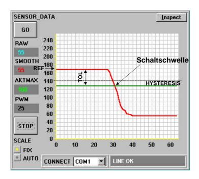
Das Messobjekt wird z.B. in der Lichtmessstrecke des Sensors platziert, dass die Bedeckung durch das Messobjekt am Empfänger einen Rohsignalwert von ca. 170 A/D-Einheiten ergibt (Lichtmessstrecke zu 2/3 bedeckt). Dieser Bedeckungswert wird zum Referenzwert (Sollwert) deklariert, hier z.B. REF=170. Die Abnahme der Signalintensität (rote Kurve im graphischen Anzeigefenster) wird durch die zunehmende Abdeckung der Lichtmessstrecke durch Bewegung des Messobjektes in den Senderstrahl hervorgerufen.
